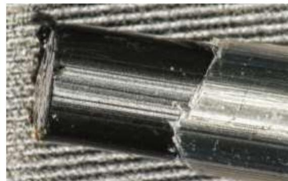
Abbildung 4. Elektrisch leitfähige BiKo-Faser
