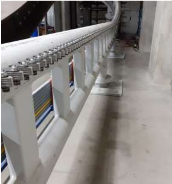
Abbildung 1: Schiene mit Zahnstange des vorangehenden Entwicklungsprojektes
