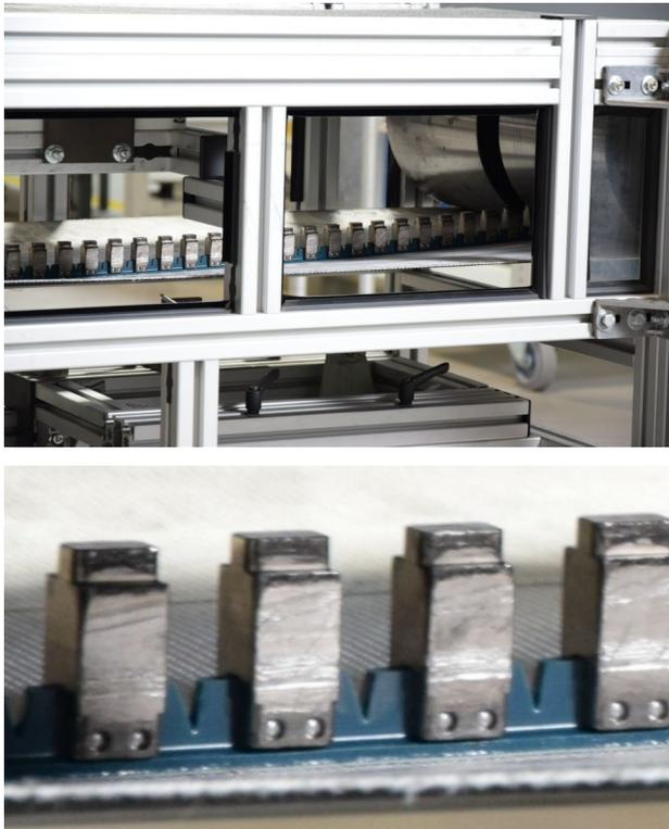
Abbildung 2: Blick zwischen Ober- und Untertrum eines Demonstrators mit auf der Laufseite befestigten Sekundärteilen der Motors (oben); Zoomansicht der Sekundärteile im Untertrum (unten)
