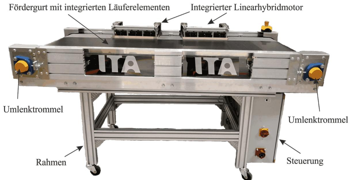
Abbildung 9: Demonstrator eines linear angetriebenen Förderbands mit im Gurt integrierten Läufer-elementen
