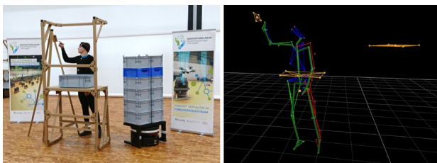
Abbildung 3. Szenario II, Position I - Physischer Versuchsaufbau im Referenzfeld und Abbildung im Motion Capturing System
