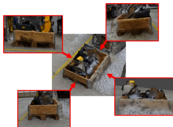
Abbildung 5. Erstellung von vier 2D-Bildern eines Objekts aus verschiedenen Perspektiven für die Objekterkennung
