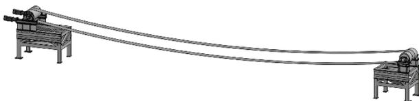
Abbildung 18: Prüfstand mit Achsabstand  $a = 12$  m
