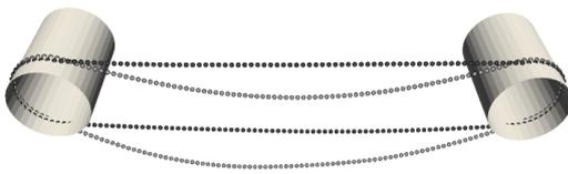
Abbildung 24: stark und schwach gespannte Partikelkette auf zwei Trommeln, gleichzeitig dargestellt
