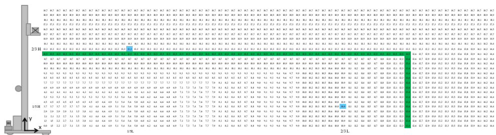
Abbildung 7. Darstellung der mittleren Spielzeit der Lagerfächer für w=1,9 , L=42m , H=10m , v_x=8\frac{m}{s} , v_y=1\frac{m}{s} , a_x=4\frac{m}{s^2} , a_y=4\frac{m}{s^2} relativer Fehler: 2%
