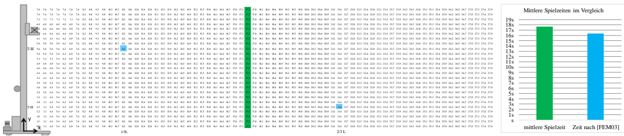
Abbildung 8. Darstellung der mittleren Spielzeit der Lagerfächer für w=0,32 , L=42m , H=10m , v_x=4,3\frac{m}{s} , v_y=3,2\frac{m}{s} , \alpha_x=1\frac{m}{s^2} , \alpha_y=4\frac{m}{s^2} relativer Fehler: 8%
