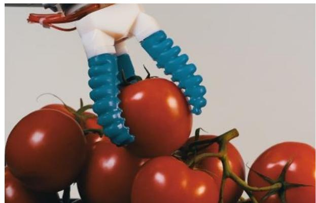
Abbildung 5. Greifbeispiel mit elastischem Dreifingergreifer
