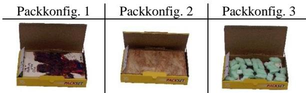
Abbildung 7. Befüllung eines DHL Packsets XS mit einem Buch auf Polystyrol-Chips (links), OSB-Platten (Mitte) und Polystyrol-Chips auf einem Buch (rechts)
