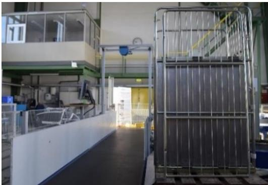
Abbildung 10. Vorrichtung zum Kippen eines Rollcontainers am Anfang des Pulkaufgabeversuchsstandes
