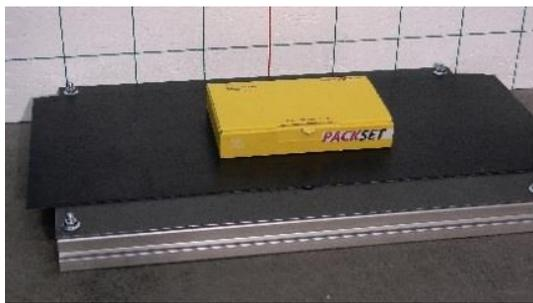
Abbildung 8. Fallversuch für DHL Packset XS auf Fördergurt
