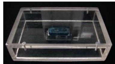
Abbildung 13. Plexiglasbox mit Datenlogger MSR165 (Außenabmessungen: 225 mm x 145 mm x 60 mm)
