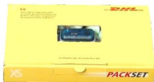
Abbildung 14. Packkonfiguration 3 mit Datenlogger MSR165
