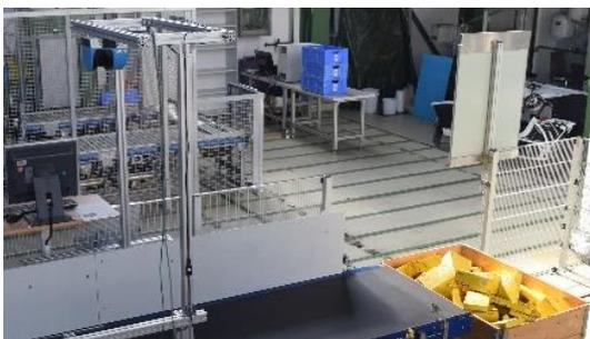
Abbildung 11. Auffangbehälter mit integrierter Wiegemesstechnik am Ende der Gurtförderer
