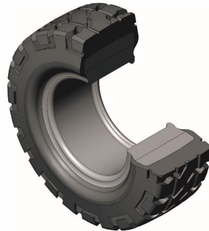
Abbildung 2. Schnittdarstellung des 3D-Modells des SE-Reifens
