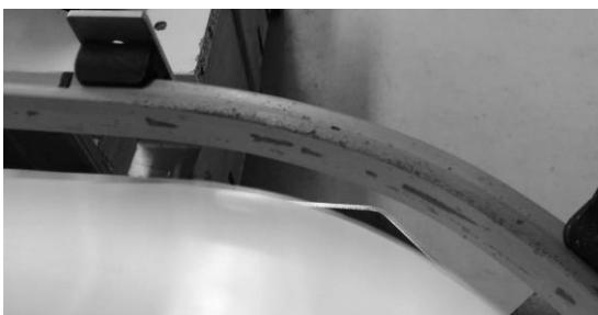
Abbildung 2. Schädigungsbild der seitlichen Führung
