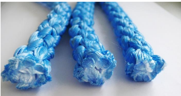
Abbildung 1: unzureichender Beschichtungseintrag in PES-Seil (weißer Kern), Ø 20mm
