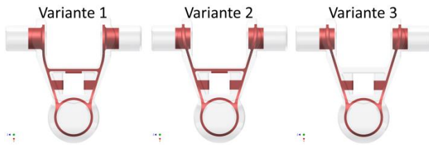
Abbildung 4. Verstärkungsstruktur in unterschiedlichen Konstruktionsvarianten [ROH15]
