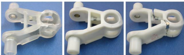
Abbildung 21. Hybride Kettenglieder nach dem quasistatischen Zugversuch: Zamak5/PP (links), Zamak5/PBT (Mitte), Zamak5/POM (rechts)
