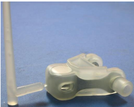
Abbildung 14. Hybrides Kettenglied nach dem Spritzgießvorgang (Zamak5/PP)
