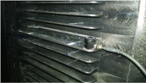
Abbildung 2. Platziertes Beschleunigungssensor auf der Lamelle.
