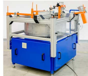
Abbildung 8. Aufbau des Verschleißversuchsstandes
