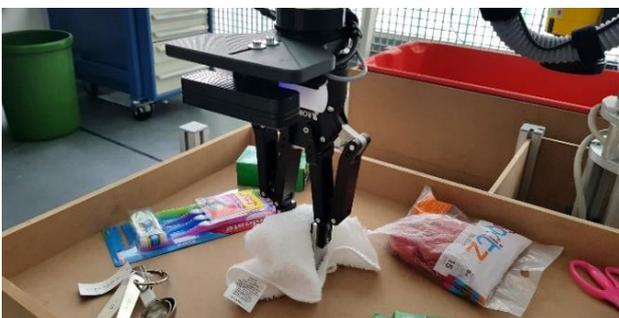
Abbildung 4: Greifen von verformbaren Gegenständen
