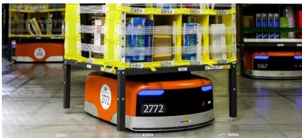
Abbildung 2: Ein mobiles Robotersystem von Amazon Robotics (ehem. Kiva Systems) beim Transport eines Regals [3]
