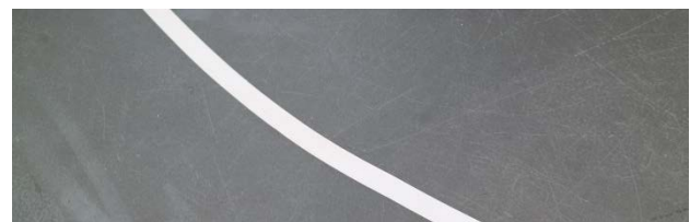
Abbildung 3. Hallenboden mit weißem Isolierband als optische Spur
