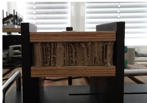
Abbildung 15. Sandwichelement mit in x-Richtung verdichtetem Kern und vorgespannter Schraubverbindung (9 kN)
