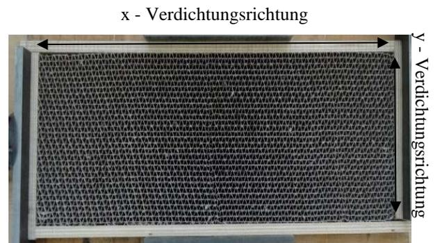
Abbildung 5. Versuchsaufbau zur Verdichtung des sinuswabenförmigen Pappwerkstoffes
