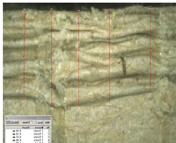
Abbildung 10. Verformungsverhalten eines unverdichteten Pappwerkstoffes hom\_H20 (Mikroskopie)
