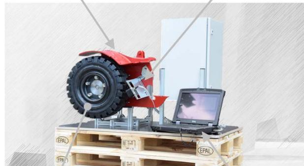
SE-Reifen mit integrierten Sensor-Transpondern Messrechner zur Leserateerfassung
