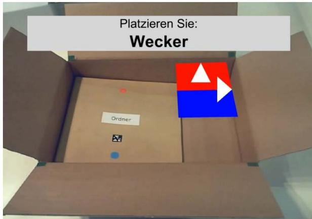
Abbildung 2. Anzeige der optimalen Position des zu verpackenden Artikels
