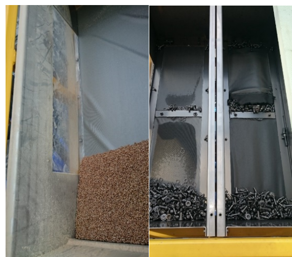
Abbildung 8. Kipprinne mit Weizen (links) und Stahlschrott (rechts)
