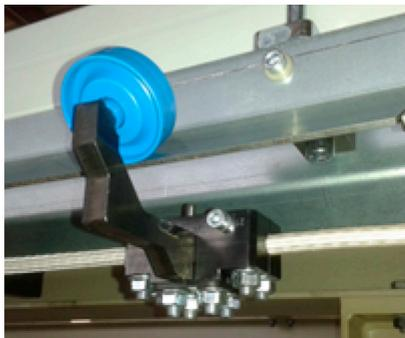
Abbildung 8. Gehänge als Antriebs- und Kraftaufnahmeelement im Fördersystem
