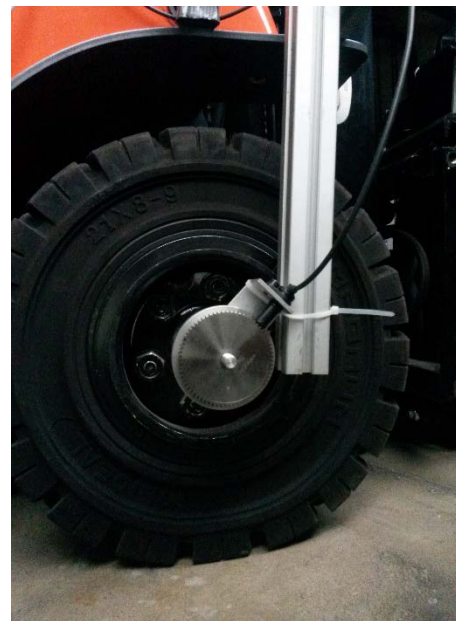
Abbildung 4: Hallsensor mit Zahnrad, montiert am Vorderrad
