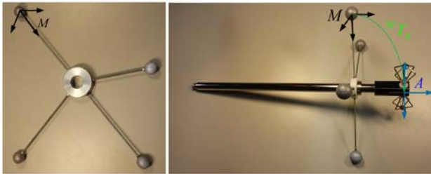
Abbildung 8. Marker einzeln (links) und Antenne mit Marker zur Messung (rechts) der Pose der Feldstärkemessung
