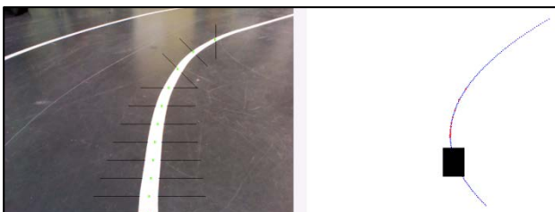
Abbildung 10: Transformation der gefundenen Punkte in die Draufsicht mit Polynom – Kurve.
