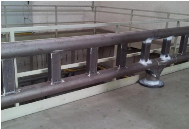
Abbildung 1. Doppelrohrschienensystem
