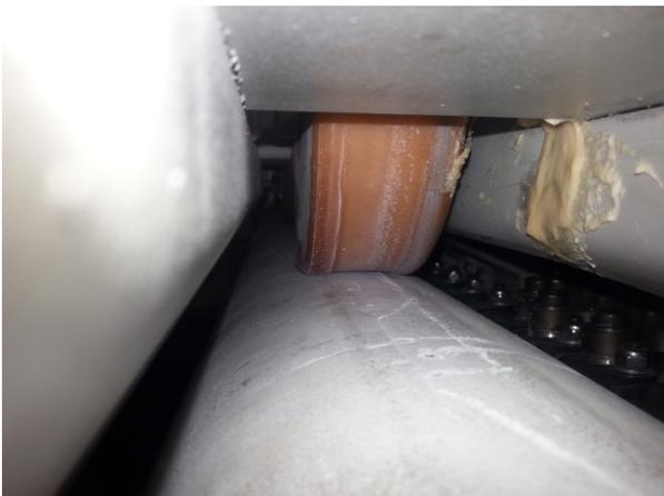
Abbildung 12. Thermisches Versagen der vorderen Laufrolle
