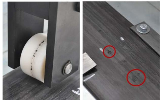
Abbildung 8: Rollversuche mit einer Polyamidrolle auf einem unidirektionalen CFK (links) mit Ausbrüchen nach rund  $2 \cdot 10^4$  Überrollungen (rechts)
