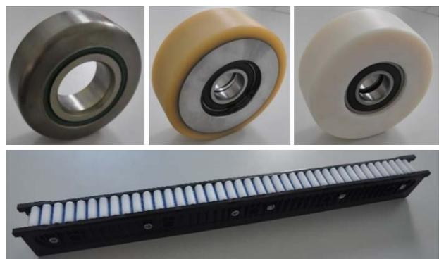
Abbildung 10: Anwendungsrelevante Grundkörper für die Untersuchungen mit balliger Stahlrolle, zylindrischen Vulkollan- und Polyamidrollen (oben v.l.) sowie einem denirug®-Kunststoffrollenelement (unten)
