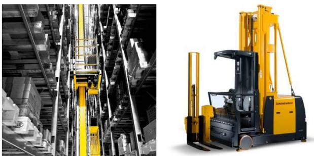
Abbildung 2: Regalbediengerät (links) [Dam15] und Kommissi- onierstapler (rechts) [Jun15] als relevante Anwendungen in der Intra-logistik
