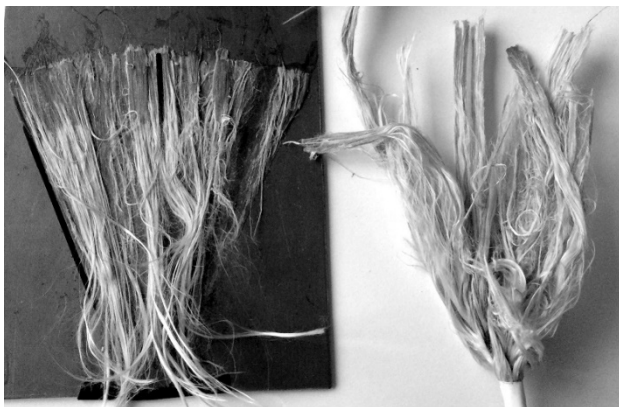
Abbildung 3: Versagensabbildung einer Klebeverbindung
