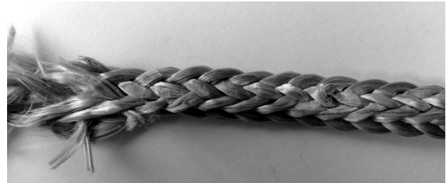
Abbildung 4: Versagensabbildung des Seiles einer nach der Prüfung gelösten Henkerschlinge
