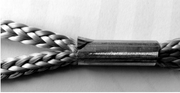
Abbildung 5: Gewaltbruch an einer Presshülse eines Dauerläufers in Folge des Zugschwellversuchs
