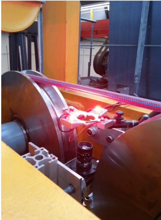
Abbildung 8. Prototypenaufbau des visuellen Seilprüfgerätes im RBG am IFT [NW14]
