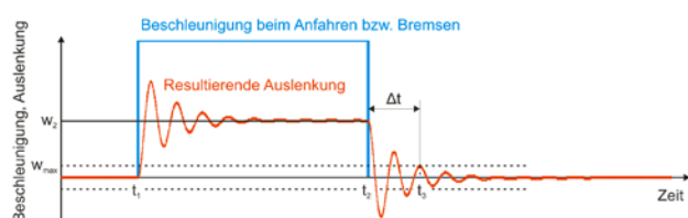
Abbildung 3. Schematische Darstellung des Schwingungsverhaltens beim Anfahren und Abbremsen eines RBG
