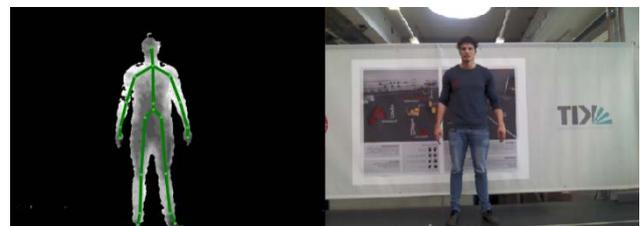
Abbildung 3. Links: Tiefenbild mit eingezeichnetem Skelett, Rechts: Videodaten der Kamera
