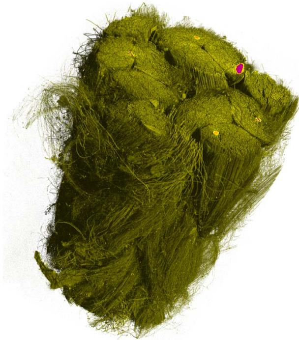
Abbildung 2. Computertomografie-Aufnahme eines biege-wechselbeanspruchten Faserseils
