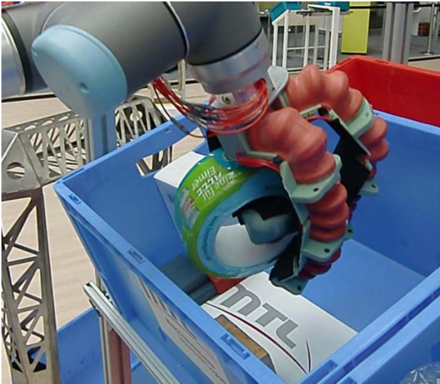
Abbildung 20. MTL-Greifer Prototyp montiert am Leichtbau-roboter mit erfasstem Drogerieartikel beim Ablegen in einer Kommissionierkiste auf der Messe CeMAT 2014
