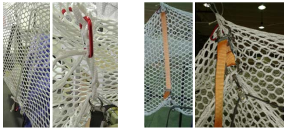
Abbildung 6: Netzverkürzer – Weiterentwicklung des Isilink® aus hochfesten Filamentgarnen zur 3D – Krafteinleitung (li.), Klemmschlussgurte als Netzverkürzer (re.)
