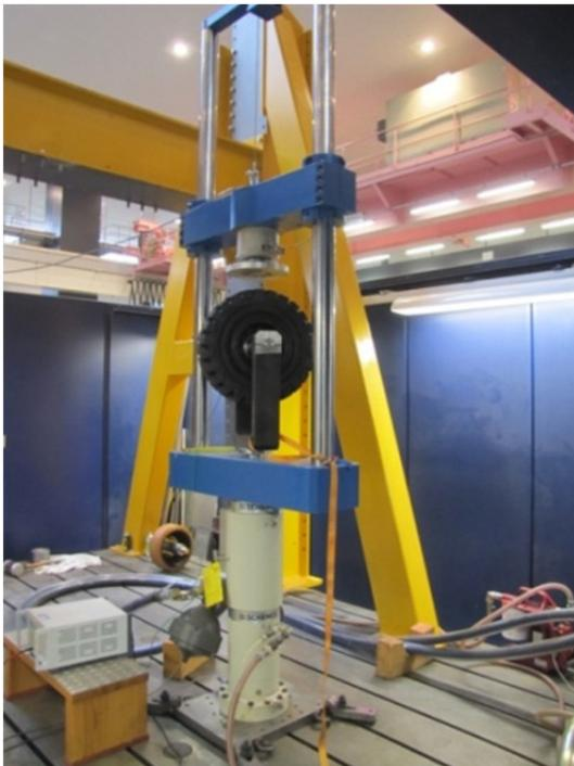
Abbildung 1. Hydropulserprüfstand
