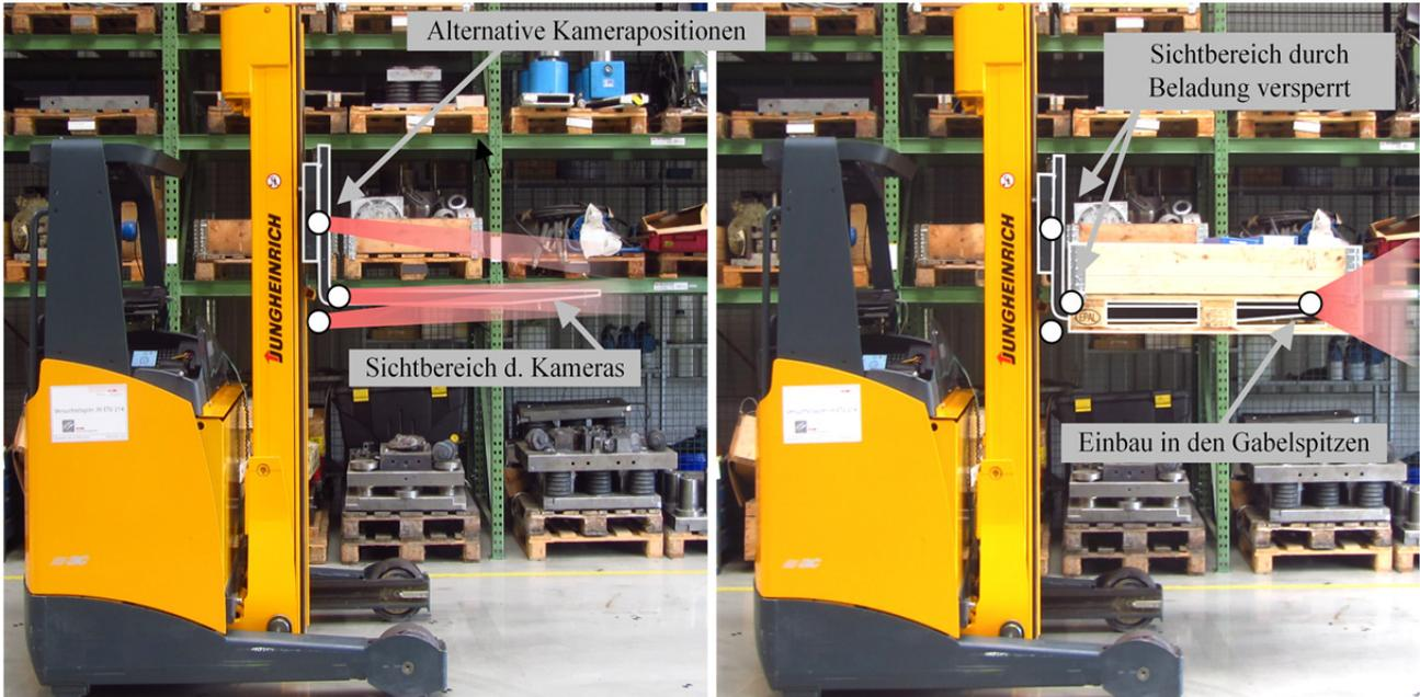
Abbildung 3. Potentielle Einbaupositionen der 3D-Kamera am Gabelstapler, Links: Situation ohne Last mit Kamerapositionen in der Nähe des Gabelrückens, Rechts: Situation mit aufgenommener Last und in die Gabelzinkenspitzen integrierter Kamera
