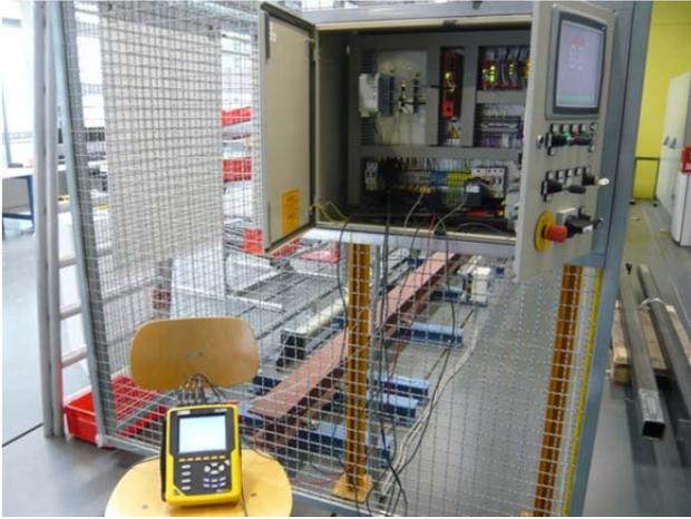
Abbildung 16. Leistungsmessung des Regalbediengeräts auf der Versuchsfläche des IFL
