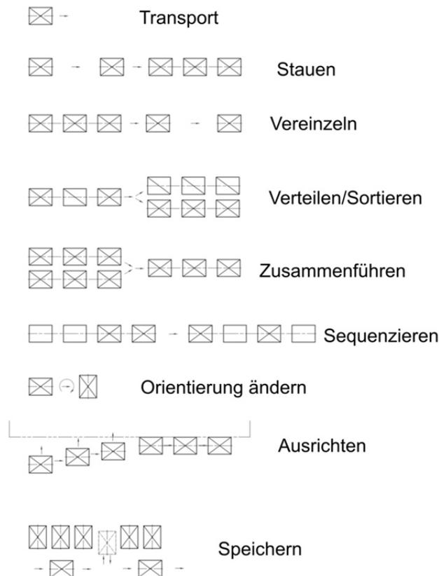
Abbildung 3. Intralogistische Funktionen einer Modulmatrix (schematisch)
