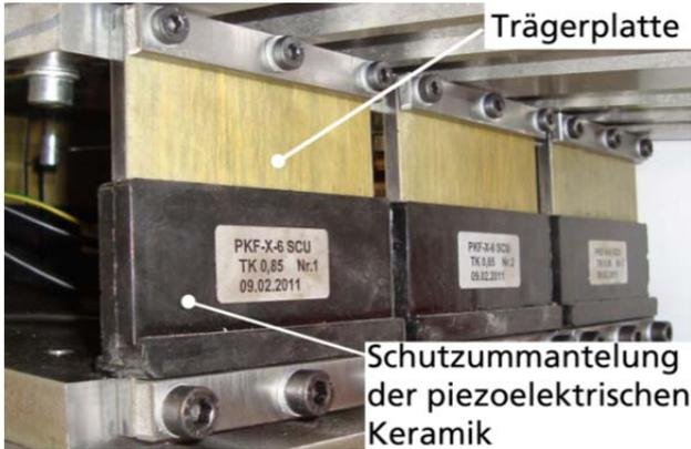
Abbildung 12. Eingebaute piezoelegte, aktive Federelemente (PKF-Elemente)
