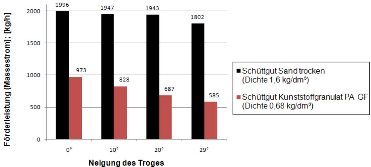
Diagramm 2: Massestrom bei einer Drehzahl von n=60/min
