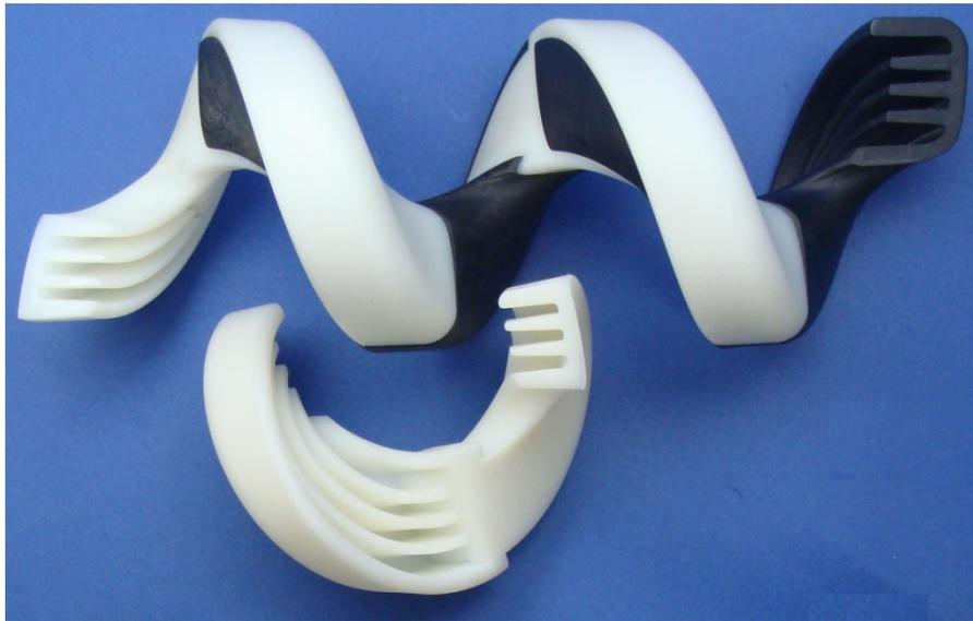
Abbildung 8: Einzelteil und vier Teile gefügt
