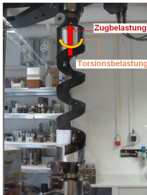
Abbildung 9: Spiralabschnitt in der Zug- und Torsionsprüfmaschine eingespannt
