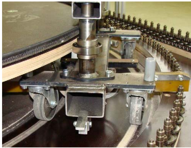
Abbildung 11: Bodenplattenverschleiß in der Fahrspur
