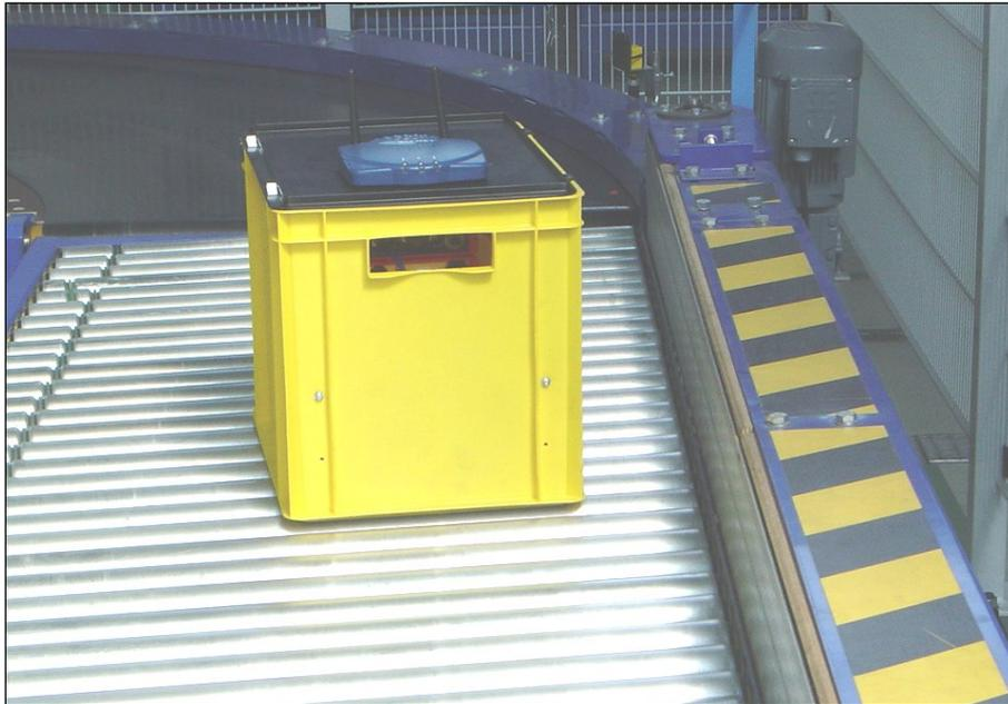
**Bild 1: Mobile Messeinrichtung mit WLAN-Übertragung auf Schrägrollenförderer**
