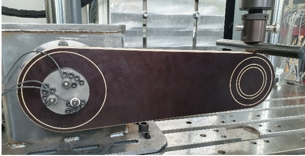
Abbildung 1. Versuchsaufbau zur Bestimmung des Kraft-Verformungs-Verhaltens unterschiedlicher Schwingen- und Verbindungsvarianten.
