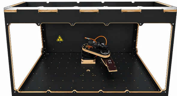
Abbildung 4. Realer Demonstratoraufbau des horizontalen SCARA-Systems, eingebaut in einer Roboterzelle in Holzbauweise
