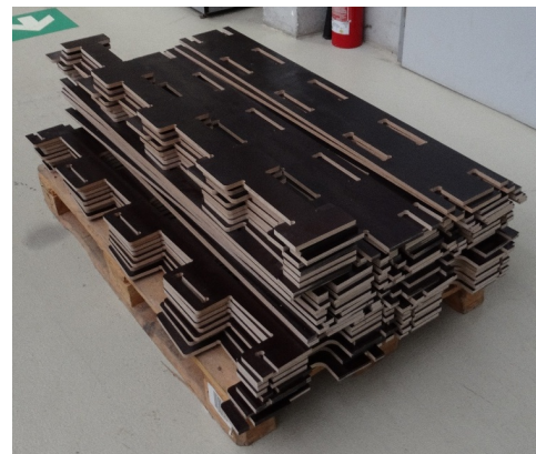
Abbildung 5: Packgröße von 2 Kranbrücken mit je 4 m Spannweite
