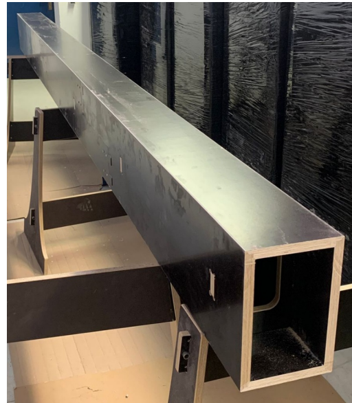
Abbildung 8: Umsetzung einer 5-m-Kranbrücke als Hohlprofil
