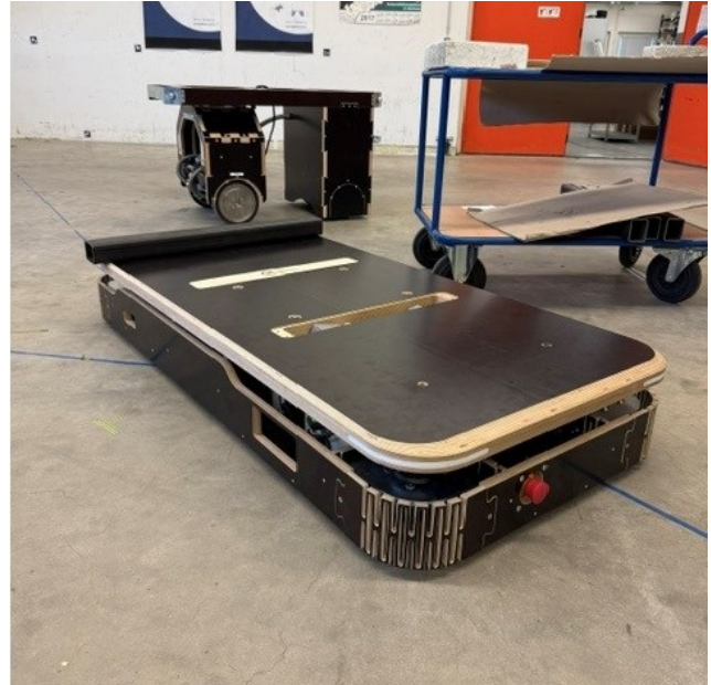
Abbildung 9: Unterfahr-FTF und Montagewagen in Holzbauweise bei der Beldrive Engineering GmbH
