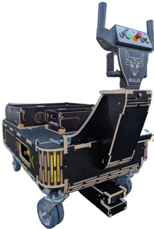
Figure 9: Prototyp eines Mitgängers: Palettentransportwagen "bullig" mit Bewegungsunterstützung im manuellen Modus und teilautonomer Bewegungsoption in eine Fahrtrichtung [14], [19]
