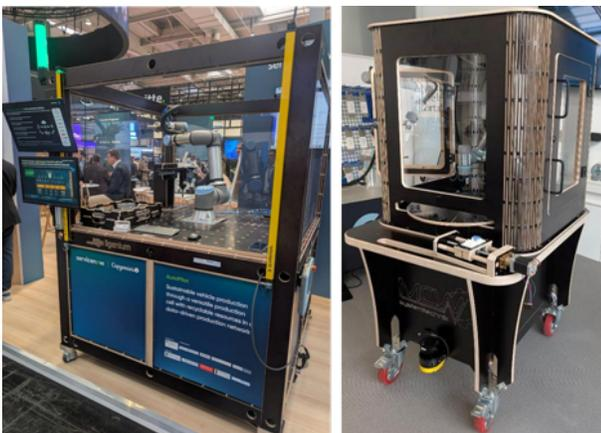
Figure 13: Gestellstrukturen für Roboter Ein- und Umhausungen (oben links: in Profilbauweise [14], [28], oben rechts: in Plattenbauweise[14]; [26], [27] incl. Drehteller in Holzbauweise; unten Mitte: als Gestellbauweise für Multi-Roboter-Technologie [14], [28])
