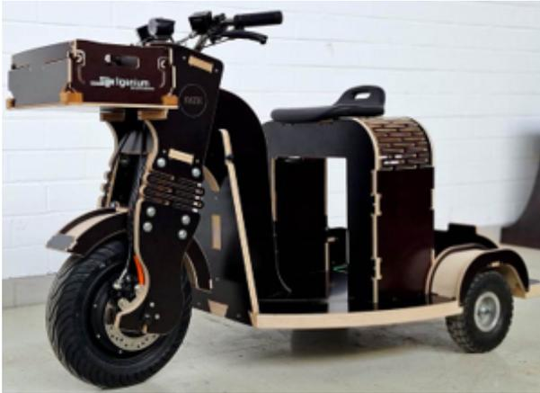
Figure 12: Prototyp eines Trikes mit E-Antrieb in Holzbauweise (Wood E-Trike) [14], [24]
