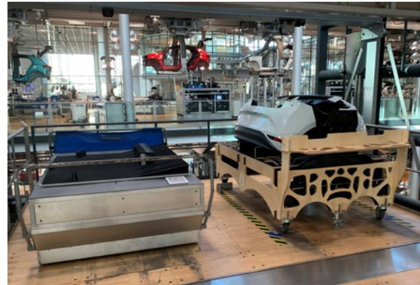
Figure 7: Ladungsträger der automobilen Transportlogistik in der Gläsernen Manufaktur Dresden (links Metallbauweise, rechts Holzbauweise) für den werksinternen Verkehr von Bauteilen in der PKW-Montage [14], [15]
