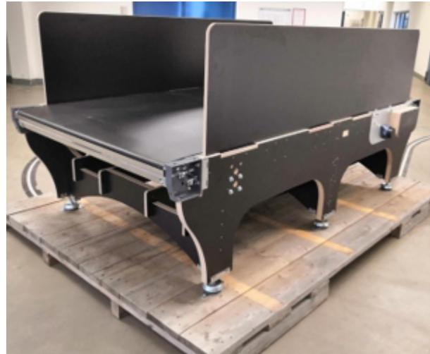
Figure 10: Prototyp eines Bandförderermoduls für Paketfördertechnik
