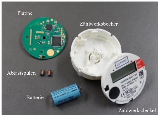
Abbildung 2: Komponenten eines Zählwerks
