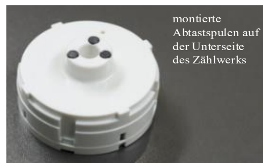
Abbildung 6: Montage der Abtastspulen auf der Unterseite des Zählwerks
