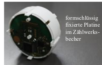
Abbildung 5: Platine ist formschlüssig im Zählwerksbecher fixiert
