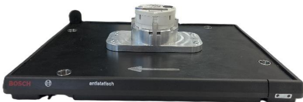
Abbildung 12: Werkstückträger mit spezieller Aufnahme für Zählwerke [60]
