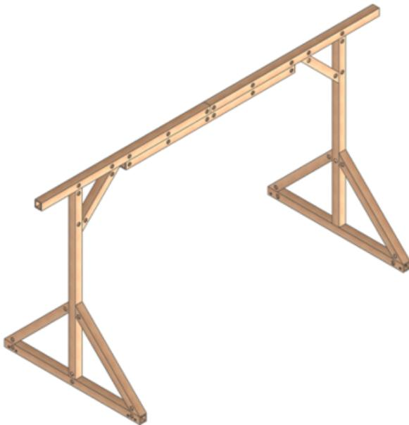
*Figure 9: CAD modularer Werkstattprotalkran mit Gesamtgewicht von 100kg und 0,5t Tragkraft, Hakenhöhe 2,3m, Fahrbreite 3m*
