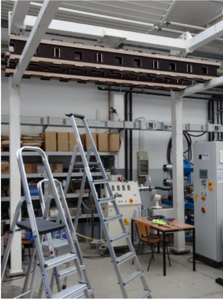
Figure 11: Aufbau modulare Doppelkranbrücke aus Birkenperrholz Eigengewicht von je 80kg und 2t Tragkraft, Hakenhöhe 3m, Fahrbreite 3,5m
