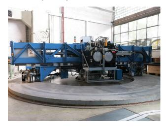
Abbildung 2. Aufbau des Radprüfstandes am IFT.
