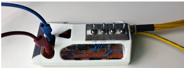
Abbildung 12. Kopplungsmodul: Energieversorgung links, Signalleitungen zum Oszilloskop und zum Messsystem rechts
