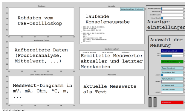
Abbildung 16. Benutzeroberfläche des Messprogramms zum Testen des Messsystem-Prototyps
