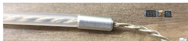
Abbildung 10. Zusammenbau: Isolierschlauch und Schutzhülle sind auf Innenleiter aufgefädelt; Messknotenplatine und Isolierfolie werden in Schutzhülle eingeschoben
